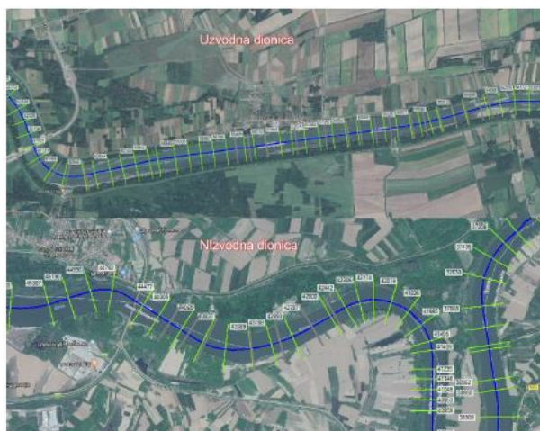
Слика 10: Диспозиција напера за једносмјерну пловидбу сектор „Јаруге –Нови Град“
