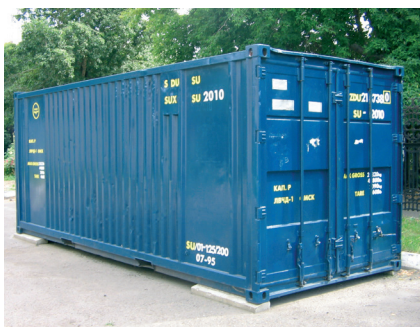
Slika 42. 20-stopni (6,1 m) ISO kontejner odgovara 1 TEU
