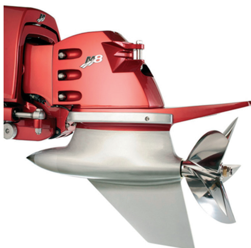
Slika 25. Amerson pogon s djelimično uronjenim vijkom na kraju horizontalno i vertikalno pomične osovine. Kardanski zglob je zaštićen crnom gumenom manžetom
