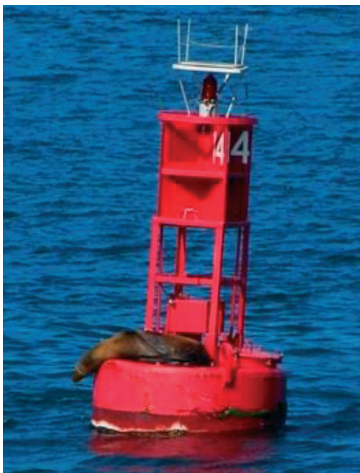
Slika 12. Plutača sa AIS AtoN baznom stanicom (ref. IECDIS EG / VTT EG presentation 25.06.2015.)
