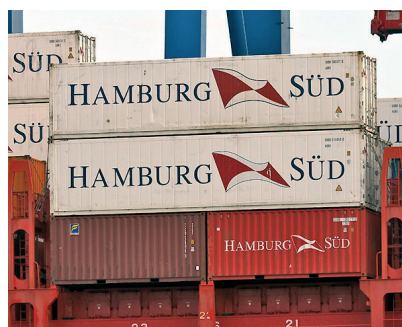
Slika 43. 40-stopni kontejneri na 20-stopnim kontejnerima
