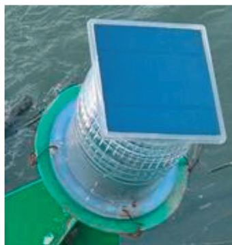
Slika 11. Solarne navigacijske lampe (reff. Пловујући web-site)
