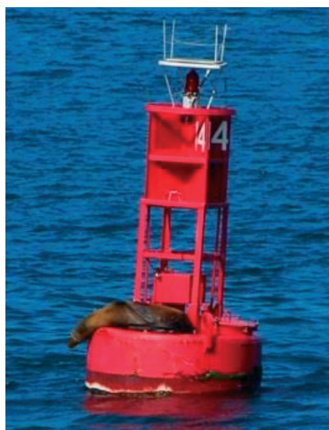
Slika 12. Plutača sa AIS AtoN baznom stanicom (reff. IECDIS EG / VTT EG presentation 25.06.2015.)
