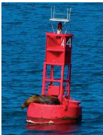
Слика 12. Бова са AIS AtoN базном станицом ( reff. IECDIS EG / VTT EG presentation 25.06.2015.)
