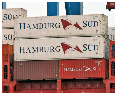
Слика 43. 40-стопни контејнери на 20-стопним контејнерима
